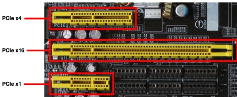
3. Stecken Sie nun die PCIe-Host-Adapterkarte in einen freien PCI-Express-Slot. Dabei spielt es keine Rolle ob es sich um einen x1, x4, x8 oder x16 Slot handelt. Nach dem Einstecken, können Sie nun das Blech der PCIe-Host-Adapterkarte am Computergehäuse festschrauben.
